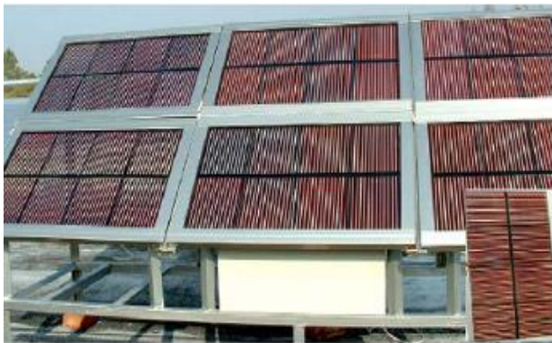
شکل ۱۳: نمایی از پنل ها با توان مجموع 640 وات
